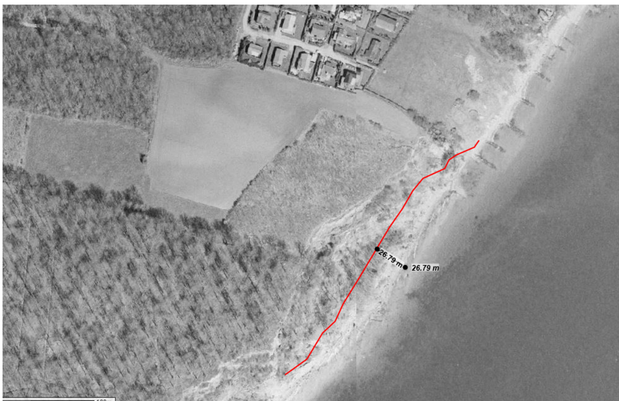
Figur B2. Luftfoto 1990. I dag er marken midt i fotoet bebygget med grundejerforeningens sommerhuse. Rød linje viser den omtrentlige vandkantslinje i 2018. Det ses, at der siden 1990 er eroderet op til ca. 26 m af kystlinjen ved Pøt Strandby. Det ses også, at erosionen er mindre mod nord, hvor der er etableret høfter.
