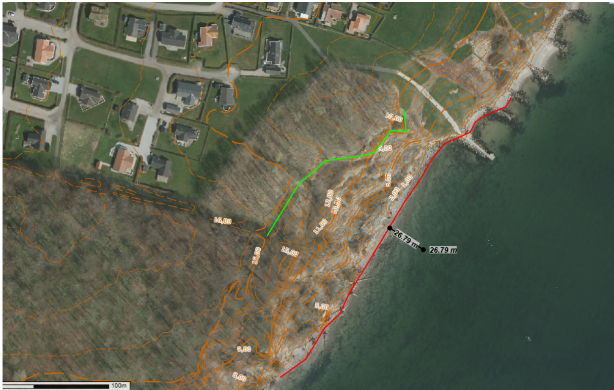
Figur B1. Luftfoto 2018. Rød linje viser den omtrentlige vandkantslinje i 2018. Opmåling (26,79m) viser afstand til vandkantslinjen i 1990. Grøn linje viser den omtrentlige skredlinje hvor lerskrænten skrider i havet.
